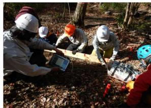
地中レーダを用いた樹木根の非破壊的探査
