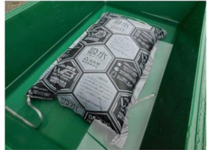
本製品（「ウォーターバスター（萩原工業KK）」）は、水に浸して90秒間揉みこむだけで、袋内のポリマー素材が水を吸い、重量10kgの土のうとして機能する。また、使用前は100gと軽量かつコンパクトな形状で保存場所も要しないといった利点もある。膨らませた「ウォーターバスター」は、大雨や洪水による浸水対策として自宅の玄関前や地下鉄の入り口などに活用できる。さらにブルーシートで覆うことで土のうのわずかな隙間からの浸水を防ぐことも可能である。
