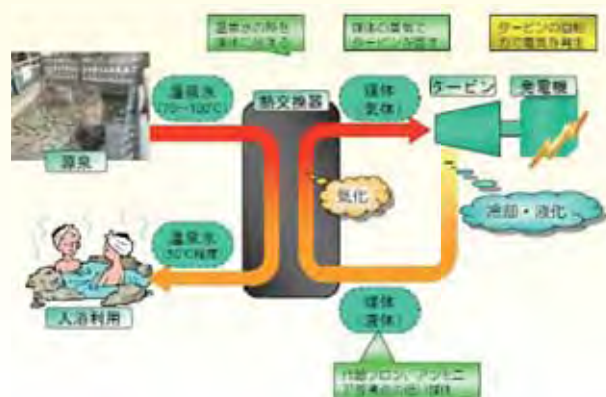
▲バイナリー発電の仕組み
