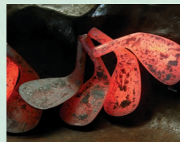
ゴルフクラブの製造が盛ん。特にアイアンヘッドは刀鍛冶の技術を応用して製造され、国産ゴルフクラブ発祥の地として知られている。
