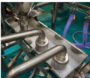
▲昔はザルを使って手で洗っていた洗米作業を行う節水型の洗米機
